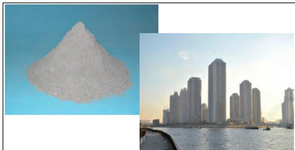
セメントとは、コンクリート(一般的にセメントに水と骨材(砂利や砂)等を混合して硬化したもの)を作るための材料の一つで、その殆どがコンクリートとして使われており、「ポルトランドセメント」、「混合セメント」、「特殊なセメント」に大別され、使用する対象(構造物)や施工方法、施工条件等に適したものを選定する。
