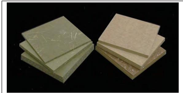
VSボード(火山性ガラス質複層板:JIS A 5440)は、白土・シラス等の火山性ガラス質材料にフライアッシュを混和したものをロックウールやグラスウールで強化した建材用のボード。不燃性や耐久性、軽量性、加工性などの特徴をもち、木造住宅の外壁下地材に利用される他、内壁材・床材・天井材・型枠材等に使用。
