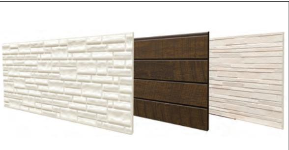
窯業系サイディングは新築住宅の約8割で採用されている板状の外壁材であり、日本産業規格 JIS A 5422として規定されている。セメント原料、繊維質原料および混和剤からなる混合原料を成型、養生、硬化した製品で、防耐火性に優れ、強くしなやかで、色・柄の品揃えが豊富なことから、最近では住宅のみならず、介護・文教・商業施設等の非住宅物件の外壁材としても採用が進んでいる。
