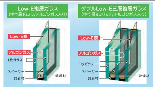
Low-E複層ガラスは2枚のガラスで構成され、ガラスの内側には熱の伝わりを抑える特殊な金属膜「Low-E膜」がコーティングされている。なかでも「エコガラスS」というグレードの製品は、ガラス間の中空層にArガスまたはKrガスを封入して断熱性能と遮熱性能を極めた窓ガラスである。ガラスが3枚の三層構造タイプもある。
