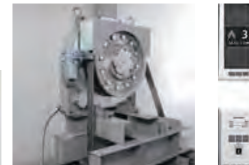
永久磁石式モーター採用ギアレス巻上機 ●戸開走行保護装置(UCMP)の機能を満たす二重系ブレーキを標準装備 ●高い走行性能と省エネ性能を両立
