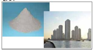
セメントとは、コンクリート(一般的にセメントに水と骨材(砂利や砂)等を混合して硬化したもの)を作るための材料の一つで、その殆どがコンクリートとして使われており、「ポルトランドセメント」、「混合セメント」、「特殊なセメント」に大別され、使用する対象(構造物)や施工方法、施工条件等に適したものを選定する。
