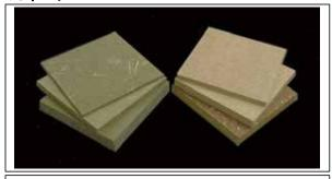
VSボード(火山性ガラス質複層板: JIS A 5440)は、白土・シラス等の 火山性ガラス質材料にフライアッシュを混和したものをロックウール やグラスウールで強化した建材用のボード。不燃性や耐久性、軽量 性、加工性などの特徴をもち、木造住宅の外壁下地材に利用される 他、内壁材・床材・天井材・型枠材等に使用。
