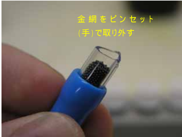
写真 3 -20 捕集管から金網の取り出し
