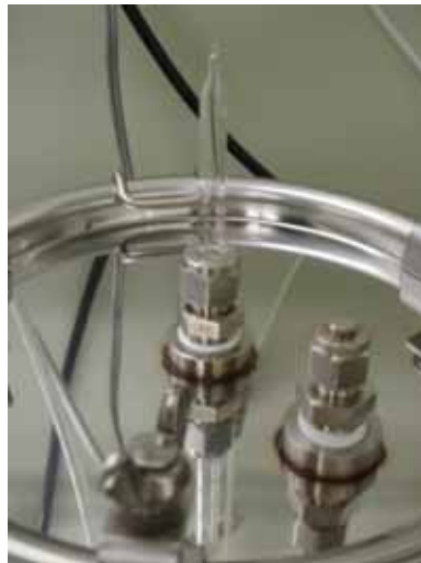
写真3-12 上部蓋捕集管設置
