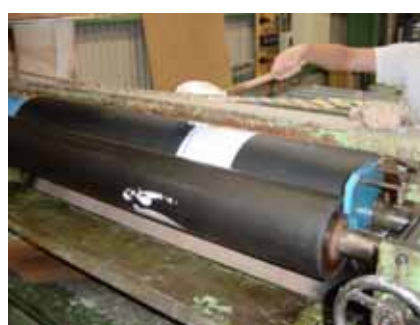
写真 3 - 2 スプレッターへの接着剤流し込み
