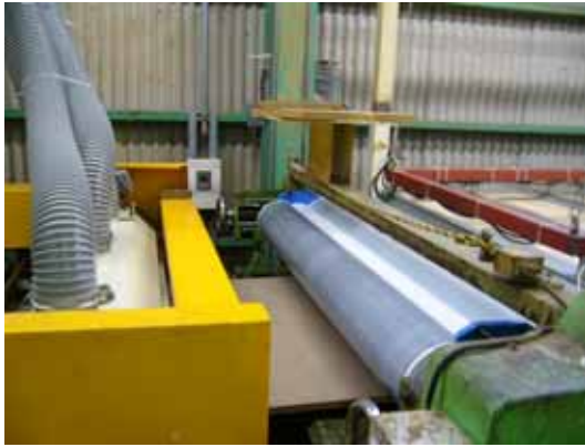
写真2 - 3 基材への接着剤塗布
