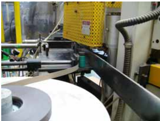
写真2 - 7 エッジテープの送り込み
