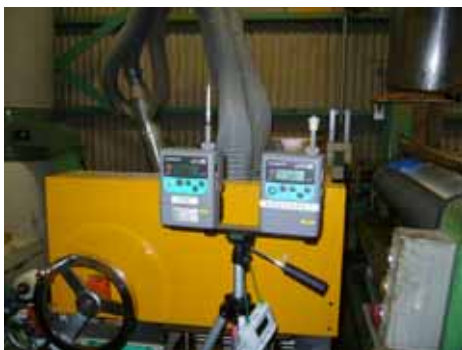
写真 2 - 17 スプレッター近辺の空気質測定 写真 2 - 18 プレス付近の空気質測定
