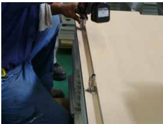
写真2 - 2 4 扉へのヒンジ取り付け
