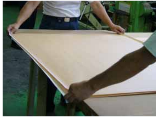
写真2 - 4 接着面へのコート紙の載置
