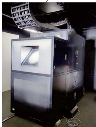
ソーラシミュレータ (キセノンランプ, 垂直入射) :人工的な照射日射の生成
