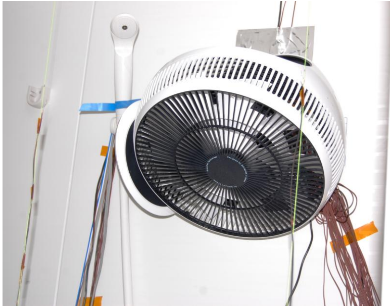
写真-5 攪拌用ファン設置状況
