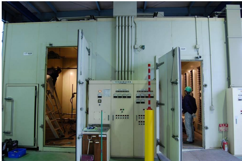
図 3.4—室型恒温恒湿室 (左: HOT ROOM 室内側、右: COLD ROOM 室外側)
