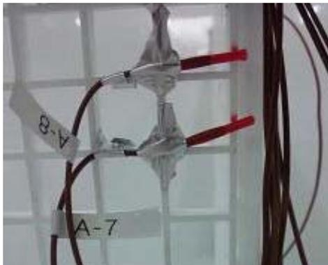
図 5.11 熱電対の取付け（導線の取出し）
