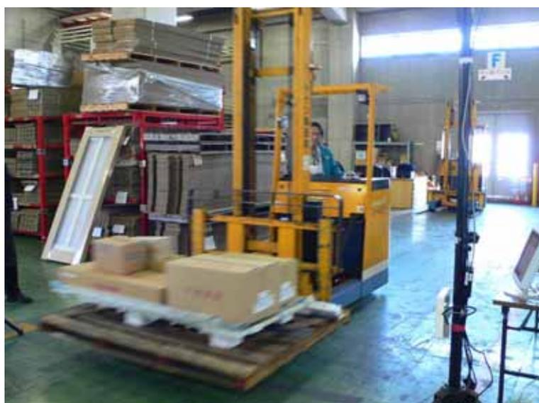
図 5-12 複数一括読み取り:高出力リーダライタの実験風景(ユニットバス)
