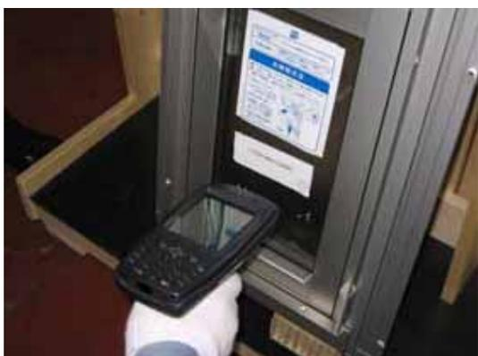
図 5-9 ガラス付完成品窓に貼り付けたタグ
