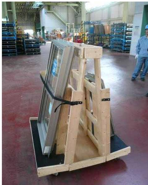
図 5-24 ガラス付完成品窓の運搬方法
