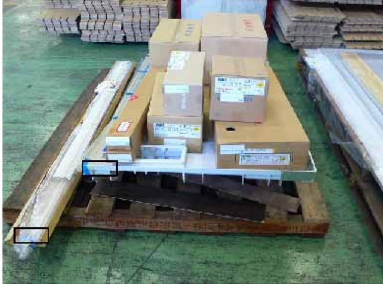
図 5-18 読み落とすことが多かったタグ(図の実線部分に貼り付けたタグ)
