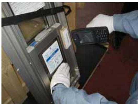
図 5-10 ガラス付完成窓の緩衝材に貼り付けたタグ
