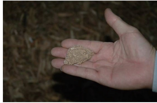
図 2.2.81 パーティクルボードチップ混入
