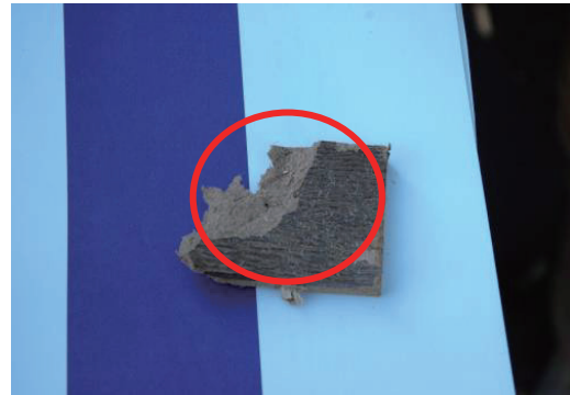
図 2.2.117 チップの中に MDF 混入(巾木類)
