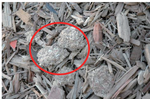
図 2.2.62 解体木くずから発生したパーティクルボードチップが少量混入
