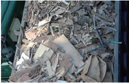
図 2.2.86 木くずの搬入状況(板材、合板類)
