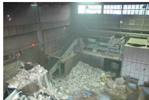
図 2.2.97 RDF製造ライン
