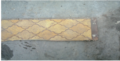
フローリング材（木材に廃プラスチック類が付着）
