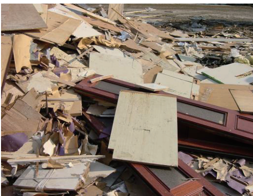
図 2.2.52 解体現場より搬入された建具、合板類
