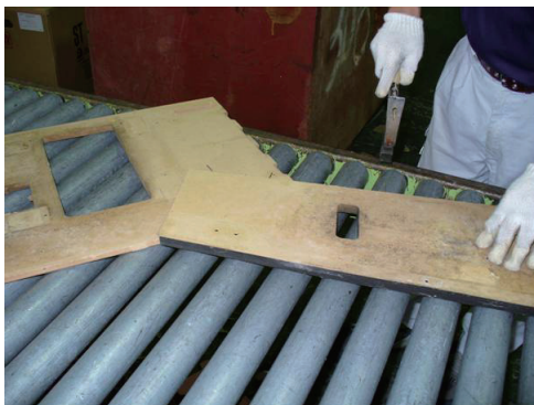
図 3.2.18 MDFの解体処理
