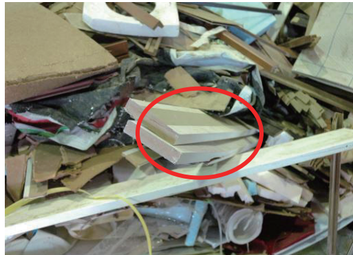
図 2.2.93 新築現場よりの窓枠類(MDF)
